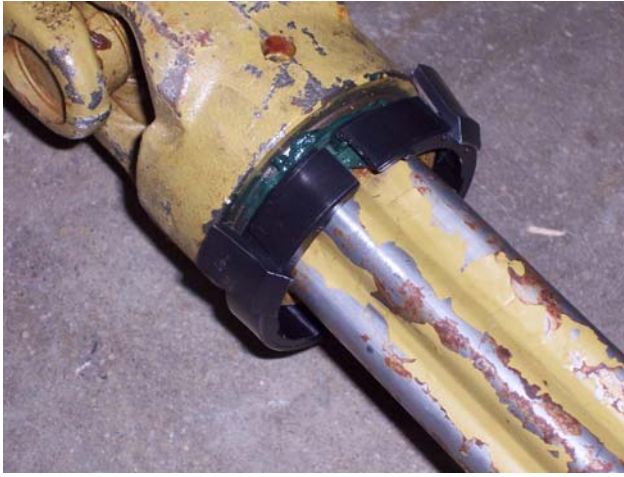
Figure 2. Le palier de nylon sied dans la rainure du joint universel; la lubrification est recommandée.
